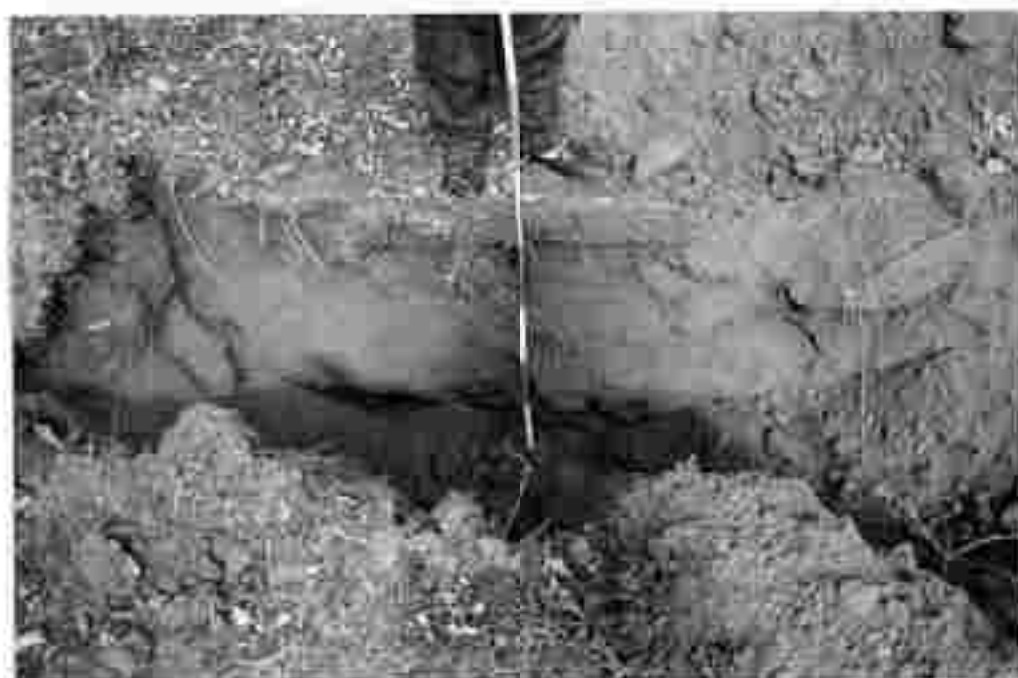
Abb. 3.4: Schurf R-5; Unter 10 cm Humus, 10 cm schluffigen Feinsand und 50 cm locker gelagertem Fein- und Mittelsand folgen sandige Kiese.
