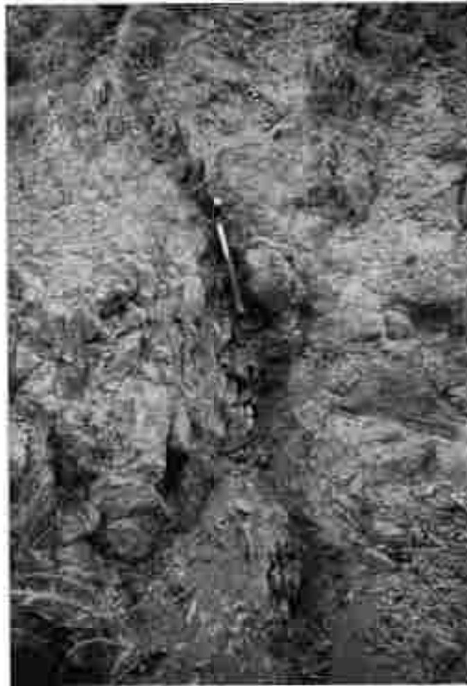
Abb.10: Streichende Bewegungsfläche mit geringmächtiger Mylonitzone. Die rotbraune Verfärbung des sandig-kiesigen Materials weist auf die Wasserdurchlässigkeit der tektonischen Zerreibungsprodukte hin.
