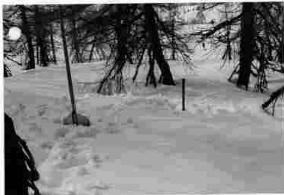
Abb. 43 zeigt die Station Linzerhaus am 9. IV. 1988. Diese Situation stellt allerdings keine Seltenheit dar, und sagt auch recht wenig über die tatsächlichen Schneehöhen aus; hauptverantwortlich für das Verschwinden dieser Station ist der Wind.
