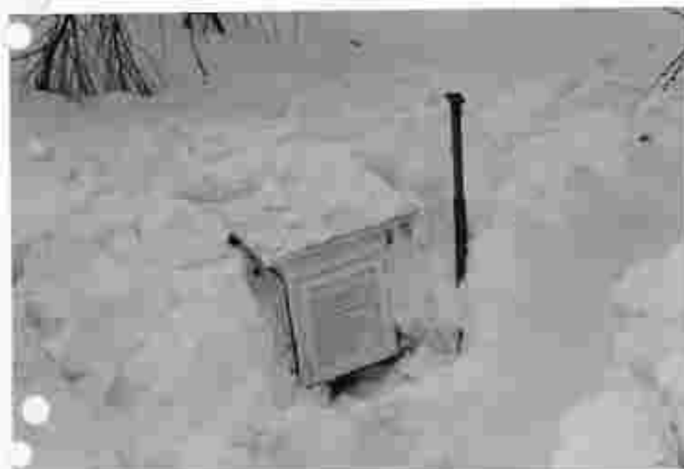
In Abb. 44 sieht man die ausgeschaukelte Station. Diese Arbeit ist eigentlich sinnlos, da eine Gasse in der Schneedecke bei derart windexponierten Gebieten wohl bald wieder mit Schnee angefüllt sein wird.
