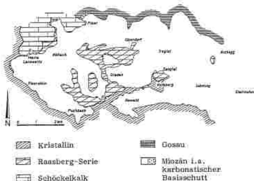
Abb.8: Geologische Karte der Umrahmung des Braunkohlenbeckens von Köflach-Voitsberg (Grundlage: H.FLUGEL 1960, Ergänzt nach Unterlagen der GKB und eigenen Aufnahmen, Quartär abgedeckt); nach POHL 1976.
