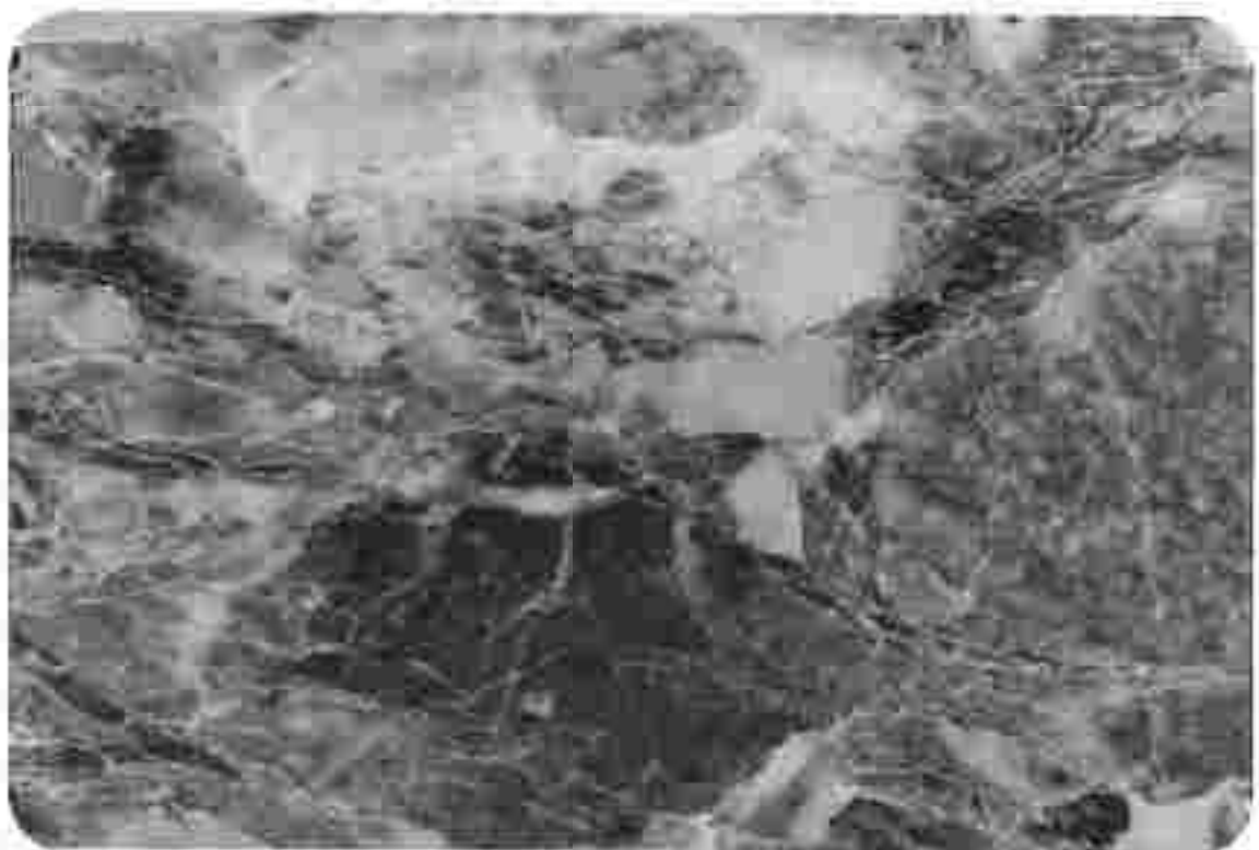
Abb. 10: Präbichl-Konglomerat vom Erzberg. Karbonatisch zementierter Typ, das rissige Gefüge ist auf die Erzberg-Sprengungen zurückzuführen.
