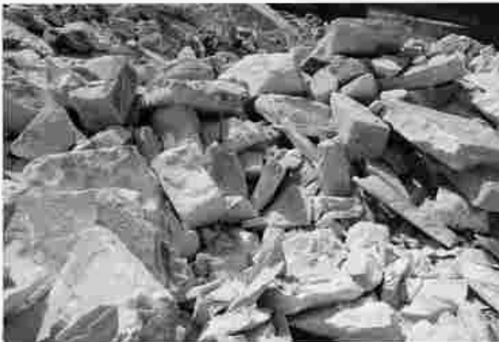
Abb. 12: Marmorbruch Kleinsölk 1220/1. Natürliches, großblockiges Bruchverhalten der Sölker Marmore.
