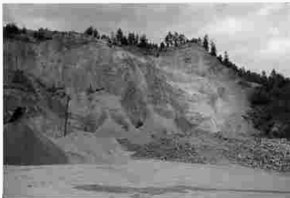
Abb. 14: Steinbruch Rötz/Trofaiach 1103/1. Die hier gewonnenen Quarzite werden vorwiegend als Hochofenzusatz eingesetzt.
