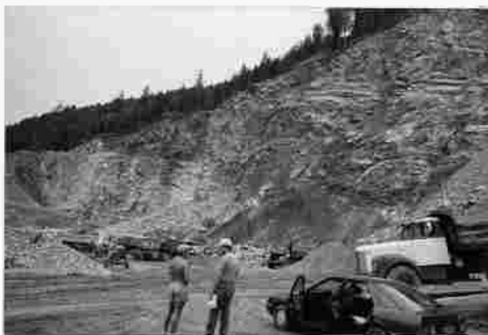
Abb. 24: Steinbruch Ponigl 1751/1. Dünnbankige bis massige Schöckelkalk.
