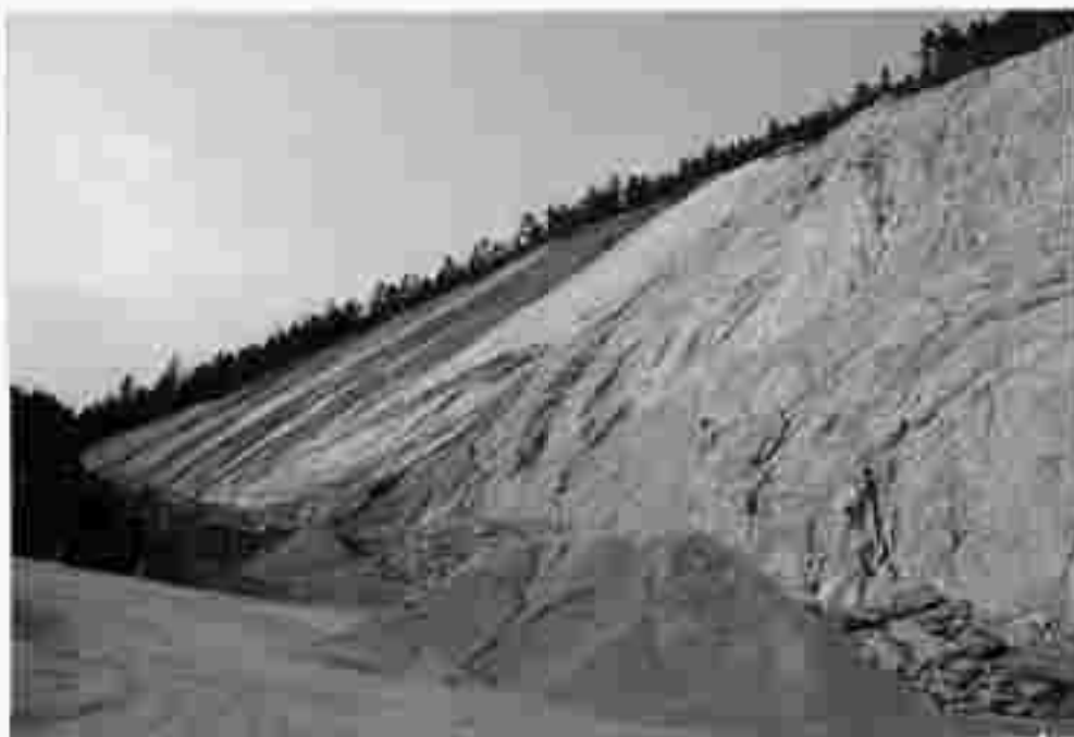
Abb. 22: Steinbruch Arzberger/Rottalberg 0730/1. Plattige bis bankige Quarzite. Verwendung als Straßenbaumaterial.
