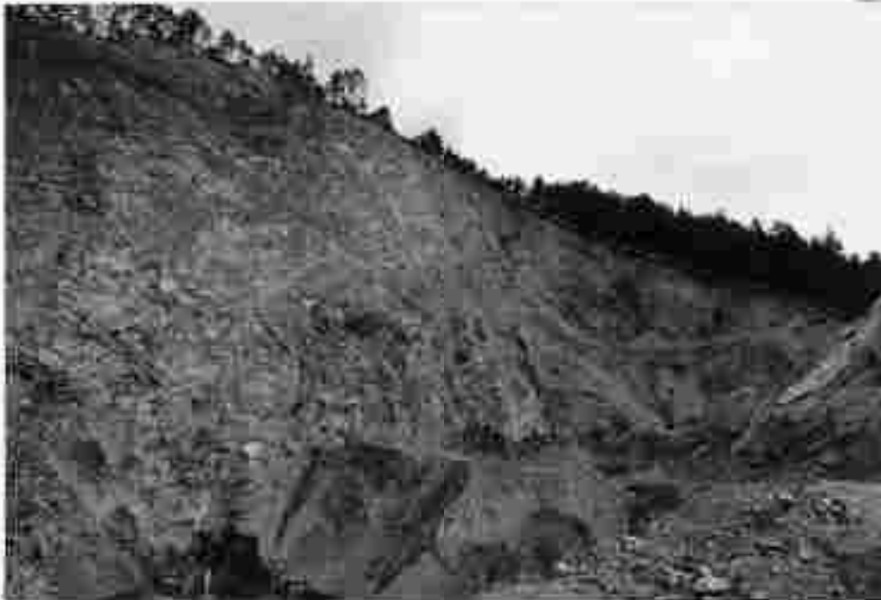
Abb 17: Steinbruch Magnolithe 1115/1, Lobming. Die hier gewonnenen Dunito werden vorwiegend in der Feuerfestindustrie eingesetzt.
