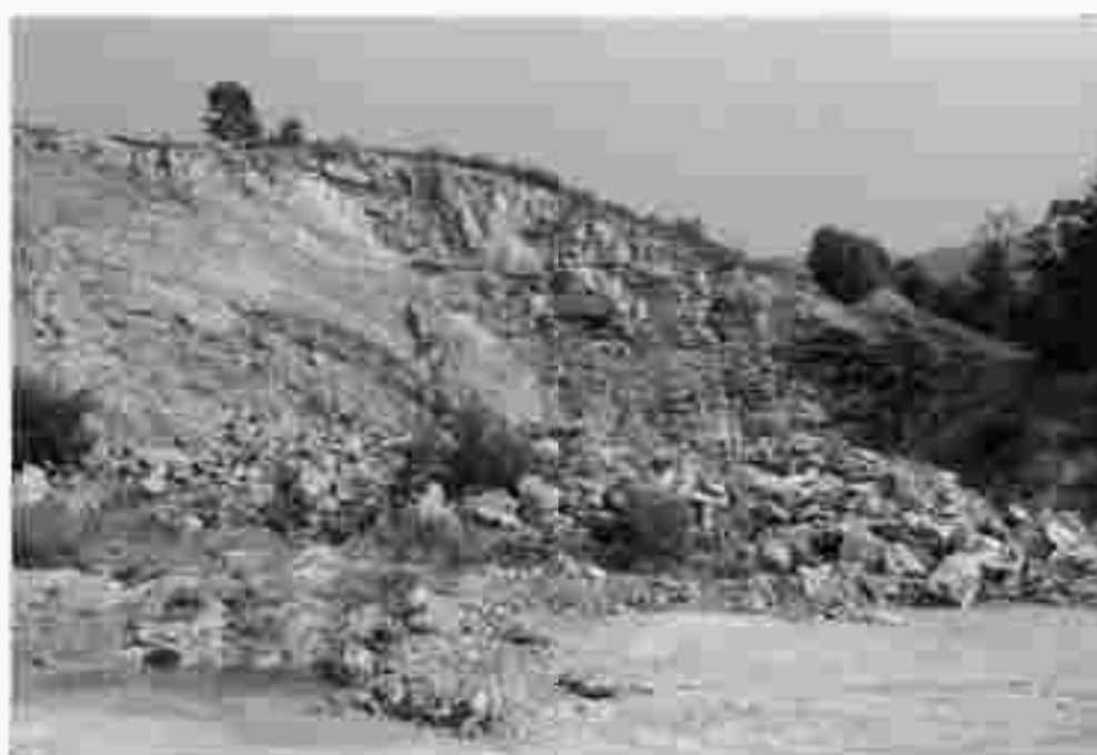
Abb.26: Steinbruch unteres Sandviertel 0724/1. Massige bis gebankte Granitgneise, Einsatz als Flußbaustein, Schotter, bedingt als Dekorgestein.
