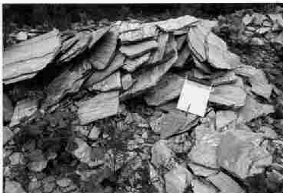
Abb. 32: Steinbruch Schifferl, 0307/2. Plattengneis, Bruchverhalten.
