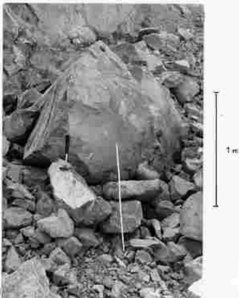
Abb. 8: Natürlich zerbrochener Basalt aus dem Steinbruch Wilhelmsdorf.
